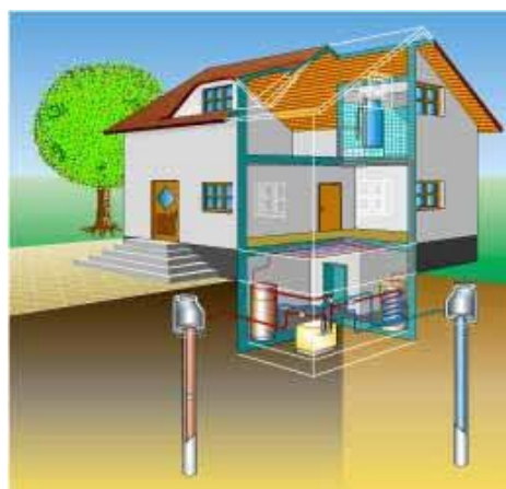
Voorbeeld kleinschalige KWO-installatie (bron website Smart Geotherm)
