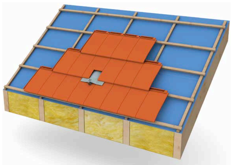
Afb. 28 Aanpassing van de dakpan om de doorgang van de haak mogelijk te maken.
