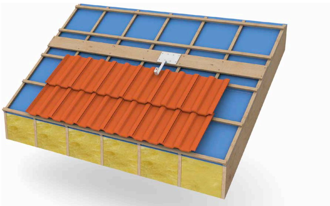
Afb. 24 Bevestiging van een haak die uitgerust is met een brede ankerplaat, waardoor men meer schroeven met een kleinere diameter kan gebruiken.
