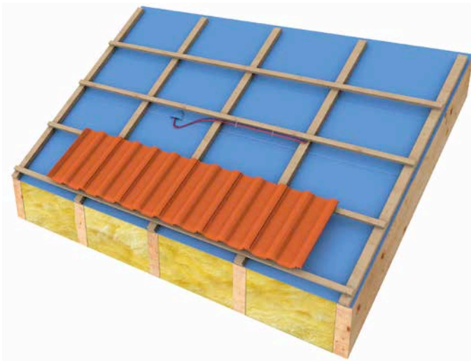
Afb. 51 Aansluiting ter hoogte van de doorboringen van het onderdak.
