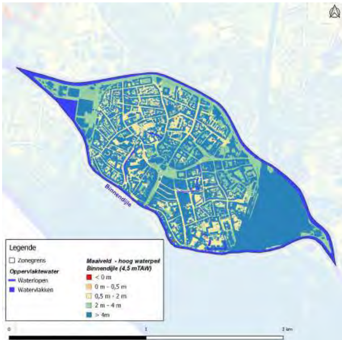
Figuur 7.23: Hoogte van het maaiveld (DSM, DHM11 resolutie 1m) ten opzichte van het hoog waterpeil van de Binnendijle (4,5 mTAW).
