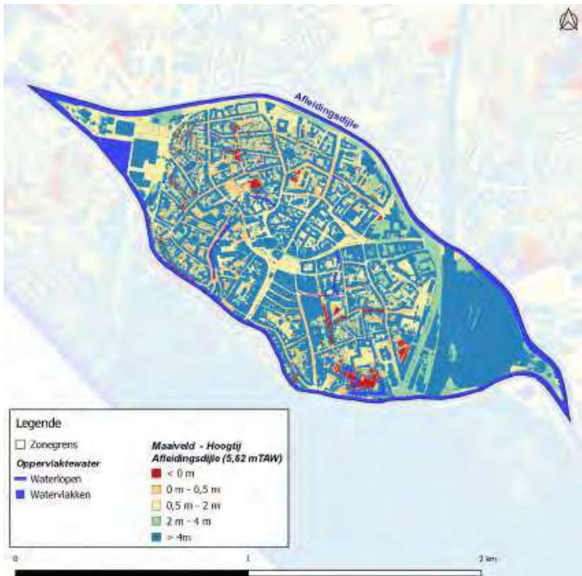
Figuur 7.22: Hoogte van het maaiveld (DSM, DHMII resolutie 1m) ten opzichte van het hoogtij van de Afdingsdijle (5,62 mTAW).
