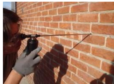
Endoscopisch onderzoek van de spouw (foto: Vivixtum)
