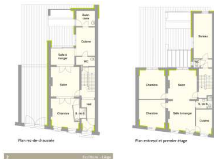
Afbelding 198 : positie isolatielaag (groene lijn) en beschermd volume (gele zone) voor een reëel na-isolatie project [ref. projectfiche "Eco"Hom, Liège", LEHR, Low Energy Housing Retrofit, PHP/ PMP, Architecture et Climat - UCL, WTCB, 2009 ]
