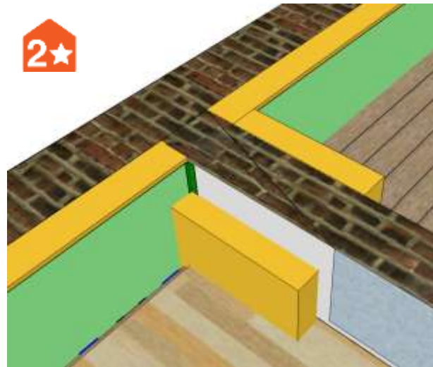
Afbeelding 69 : aansluiting binnenisolatie – inbindende muur, via retourisolatie (standaarddetail, schematische 3D voorstelling)
