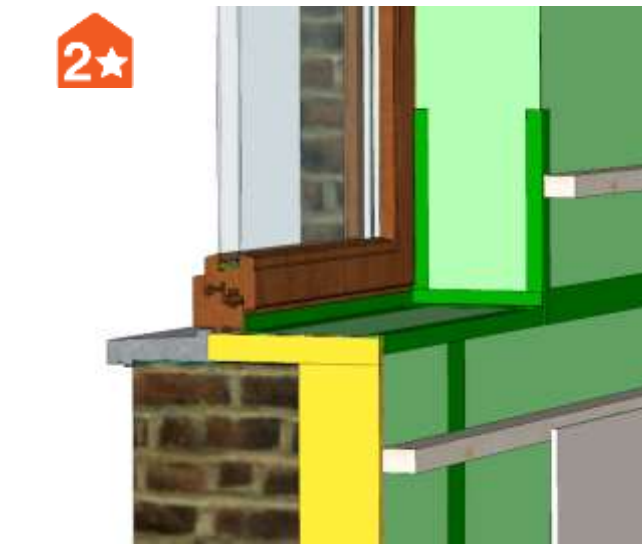
Afbeelding 167 : aansluiting binnenisolatie –venster: onderrand (standaarddetail, schematische 3D voorstelling)
