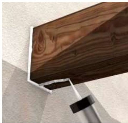
Afbeelding 111 : luchtdichting van de aansluiting houten balk – muur (en eventuele barsten of holten in het hout, die de luchtdichtheid zouden kunnen hypothekeren)
