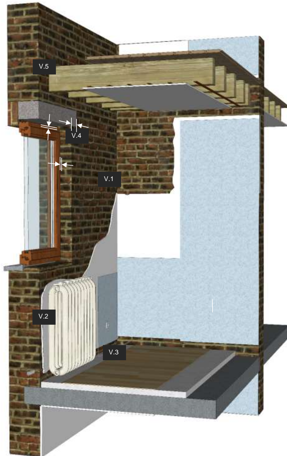
Afbeelding 29 : Mogelijke situatie vóór het aanbrengen van binnenisolatie: analyse bestaande situatie en uitvoering van voorafgaandelijke werken
