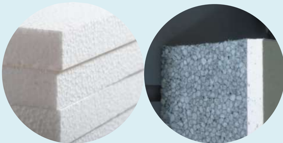
Afbeelding 24 : EPS (links) versus geëlastificeerd EPS (rechts)
