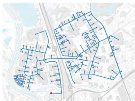
Figuur 10: Schematische weergave van het scenario voor een warmtenet op Mechelen Noord I en II (links) en het scenario voor een warmtenet op Mechelen Noord I en II met parallel een trace richting het stadscentrum van Mechelen en de nieuwe ontwikkeling op de voormalige site van CG Power Systems (rechts). Bron: Ingenium
