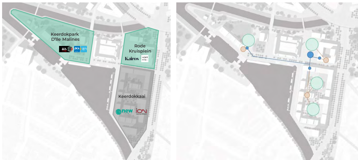
Figuur 2: Overzicht met de projectontwikkelingen (links) en schema van het energienet dat zal gerealiseerd worden door Aquafin en Noven (rechts)
