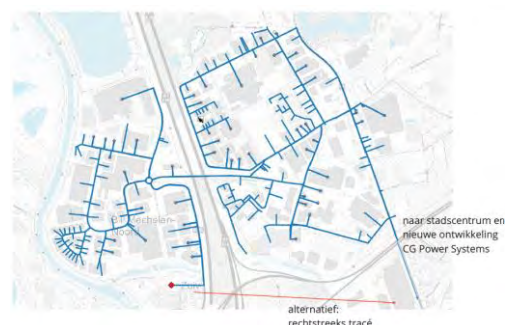
Figuur 10: Schematische weergave van het scenario voor een warmtenet op Mechelen Noord I en II (links) en het scenario voor een warmtenet op Mechelen Noord I en II met parallel een trace richting het stadscentrum van Mechelen en de nieuwe ontwikkeling op de voormalige site van CG Power Systems (rechts). Bron: Ingenium
